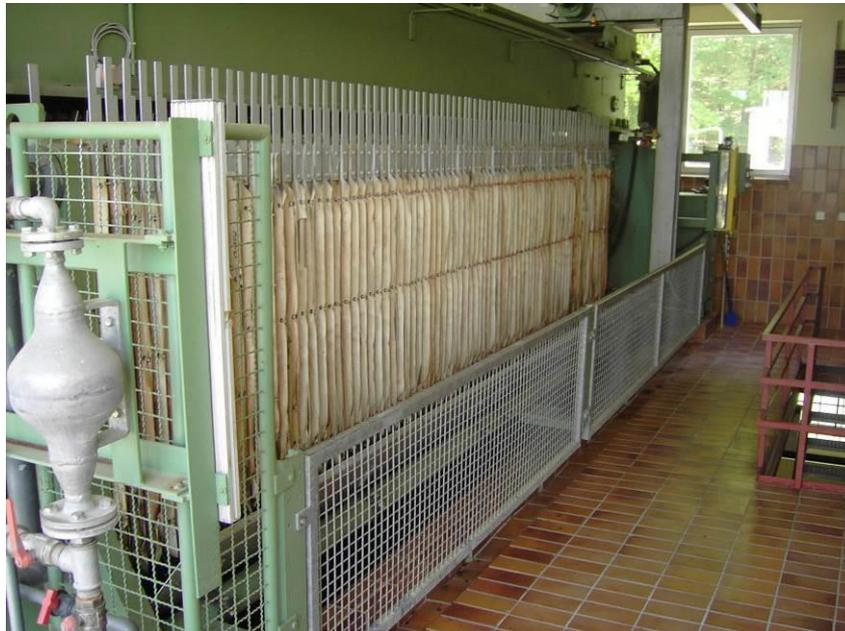
**Abbildung 14: Kammerfilterpresse**
