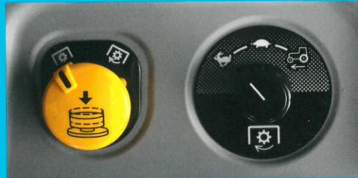
Zapfwellensteuerung bequem rechts neben dem Sitz aktivierbar. Zapfwellenzuschaltung Normal-/Softanlauf und Start-Stopp-Automatik serienmäßig
