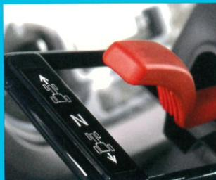
Bequemes Umschalten der Fahrtrichtung direkt unter dem Lenkrad (dadurch nur ein Fahrpedal notwendig)
